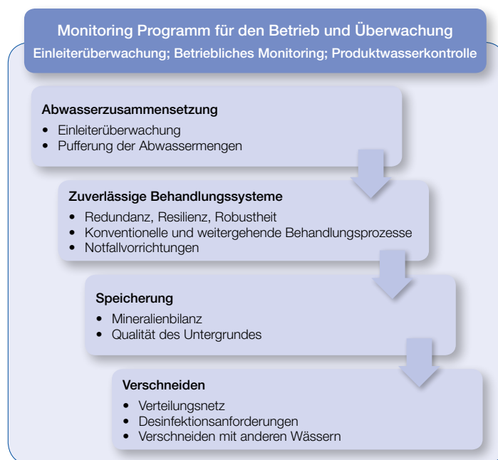
Abb. 2: Elemente eines Wasserrecycling-Systems (nach Drewes & Horstmeyer, 2016)
