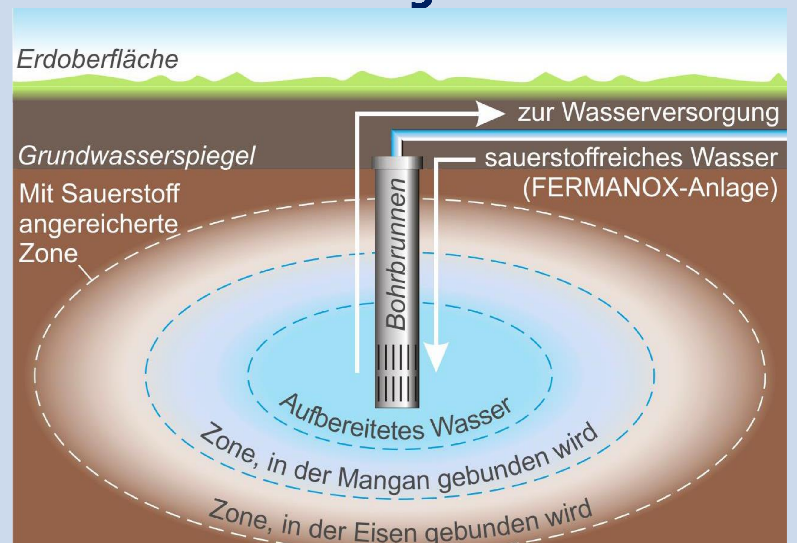
Abb. 3. Prinzip der unterirdischen Aufbereitung (Quelle: fermanox.de)
